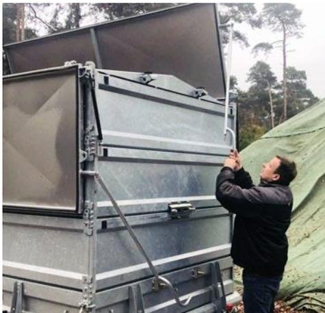
Dachklappen Verschlüsse mit Gestänge
